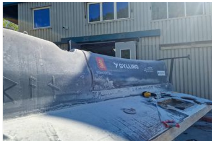
SLIPER NED: Båten trenger bedre oppdrift. Her slipes den, slik at det kan støpes på pongtonger, som vil hjelpe båten med oppdriften.
